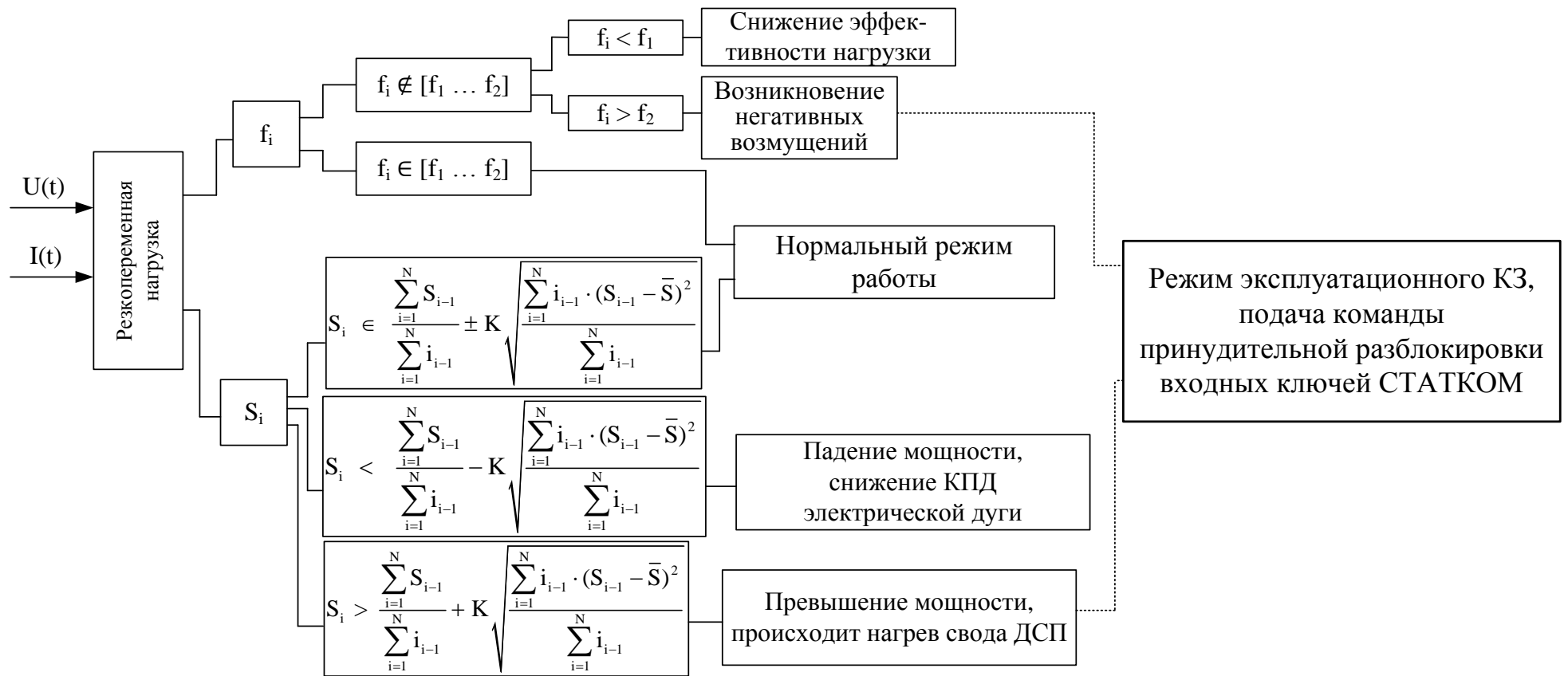
Рисунок 8 – Схема действия системы управления СТАТКОМ при возможных режимах работы электроприемника электротехнического комплекса «ДСП – СТАКОМ»
