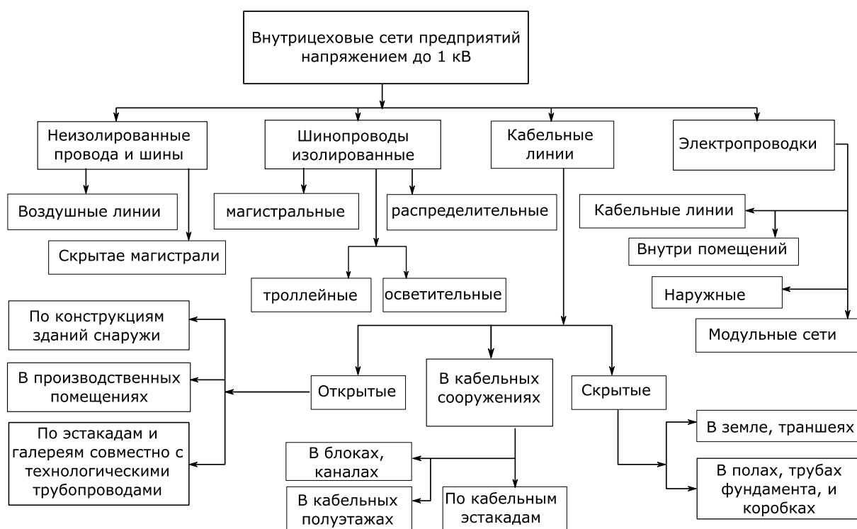
Рисунок 1.7 – Классификация цеховых сетей по конструктивным признакам
