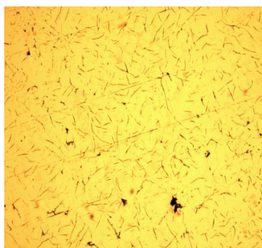
Рис. 5. Распределение графита при вводе ФС75Ba1 (0,3 %), x100. Режим плавки с термовременной обработкой
