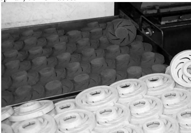
Рис. 3. Основные стержни, полученные по технологии «Cold-Box-Amin»
