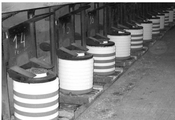
Рис. 4. Собранные в стопы формы под заливку на конвейере, полученные по технологии «Cold-Box-Amin»
