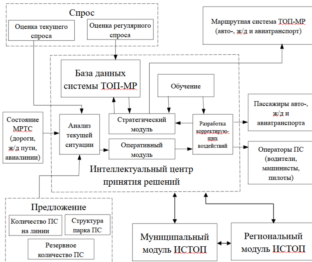
Рис. 1. Схема концептуальной модели межрегионального модуля интеллектуальной системы транспорта общего пользования
