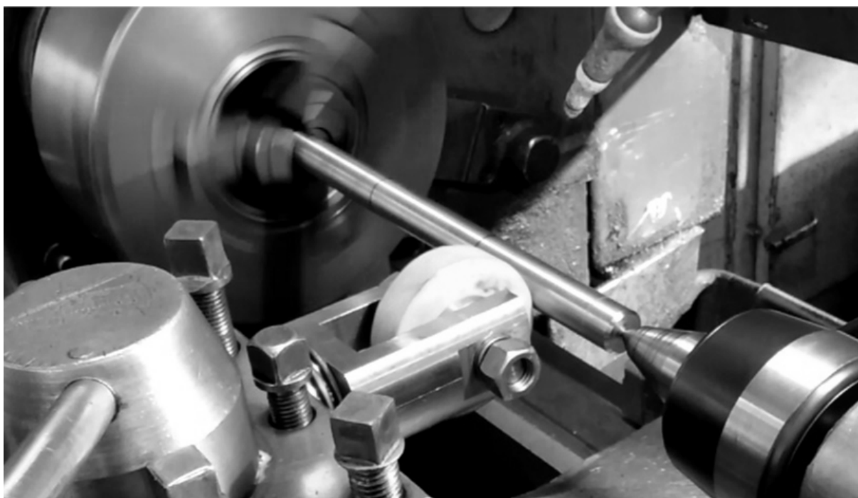
Рис. 1. Фотография процесса накатывания иррегулярного микрорельефа
