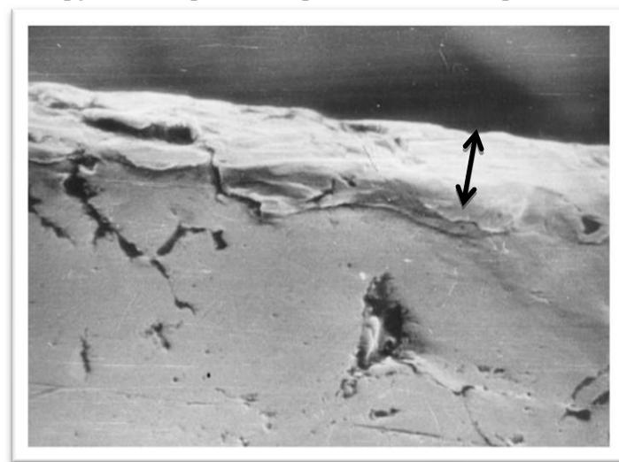
Рис. 7. Разрушение кромки образца из ЧВГ-45,  $\times 500$
