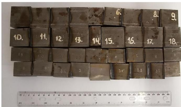
Рис. 1. Фотография темплета, разрезанного на образцы
