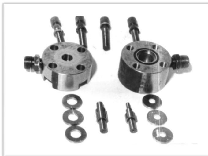
Рис. 4. Кавитационная камера и кольцевые образцы для испытаний
