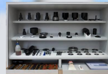
Учебный стенд «Bearing» Монтаж-демонтаж подшипников FAG
