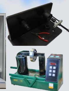
Учебный стенд «Bearing» Монтаж-демонтаж подшипников FAG
