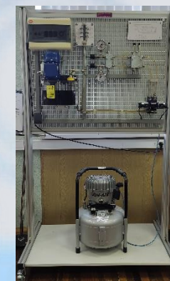
Стенд по изучению и обслуживанию систем смазки
