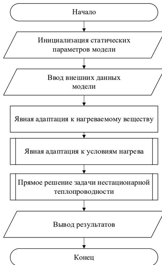
Рис. А.3 – Обобщенный алгоритм работы программы с подпрограммой адаптивного расчета коэффициента теплообмена
