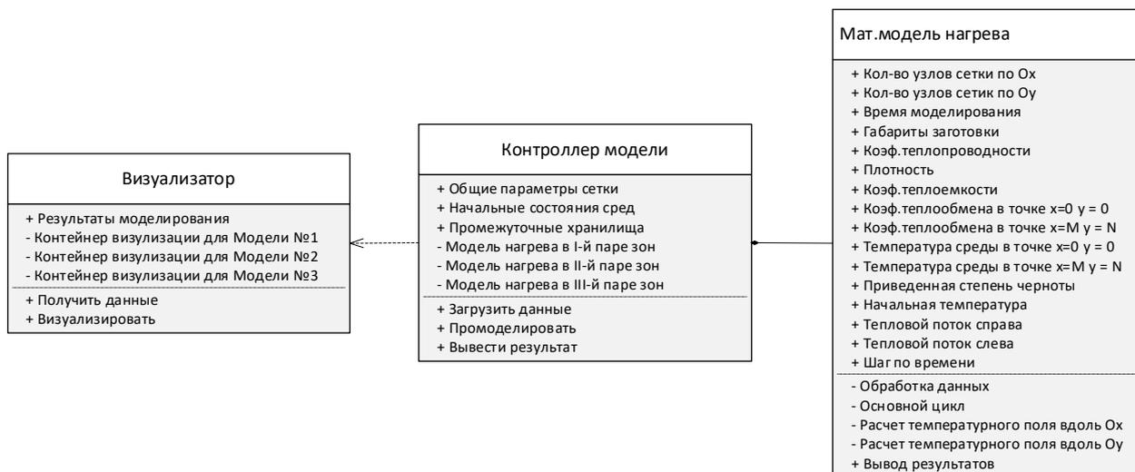
Рис. 30 – UML–диаграмма классов программы нестационарного теплопереноса
