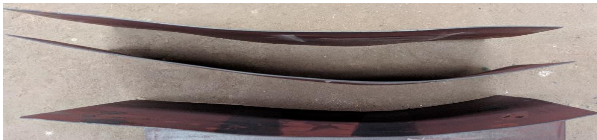
Рисунок 2 – Профиль полосы при физическом моделировании с использованием скоростной асимметрии с толщины h_0 = 2 мм на h_1 = 1,4 мм (Сверху вниз: коэффициент асимметрии увеличивается (1,00–1,15))
