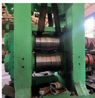
Рисунок 4 – Экспериментальные ступенчатые валки на стане 350 (г. Аньшань, Китай)
