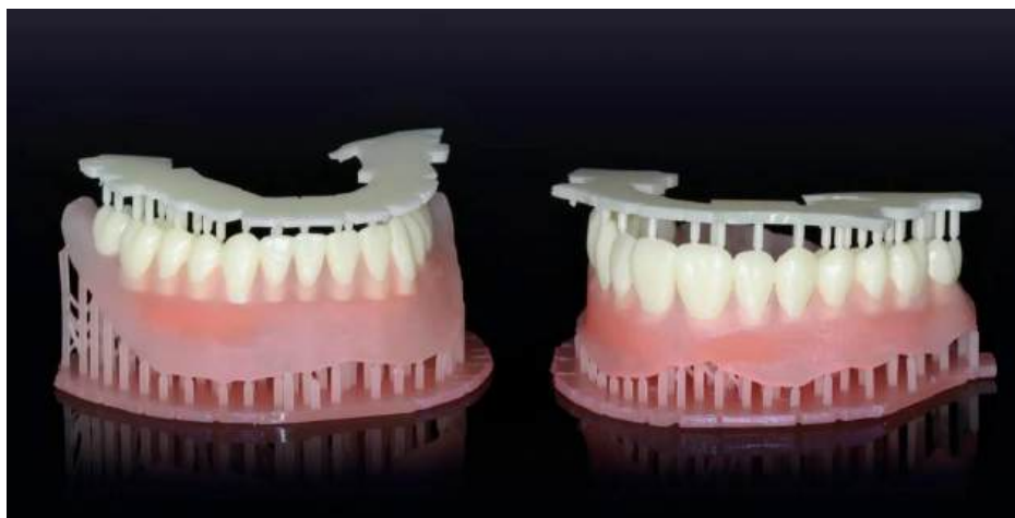
Рисунок 1 – Протез челюстей, изготовленный при помощи аддитивных технологий
