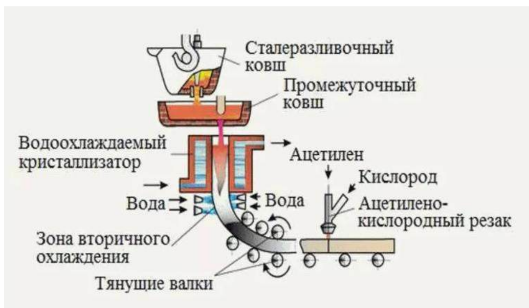
Рисунок 1 – Устройство МНЛЗ
