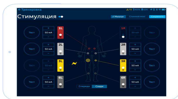
Рис. 3. Вид интерфейса экзоскелета ExoAtlet Bambini
