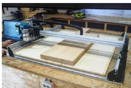
Рисунок 3 Заготовка-ступень из бука на столе станка ЧПУ
