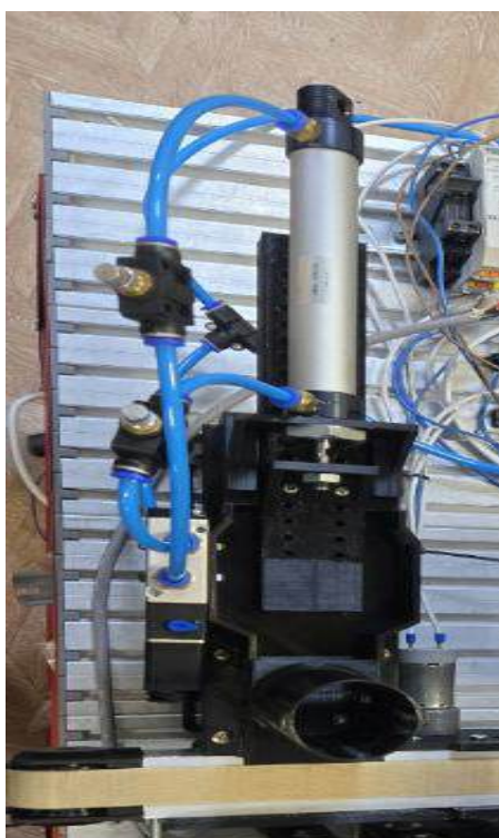
Рисунок 2 – Магазин для выдачи заготовок на конвейер
