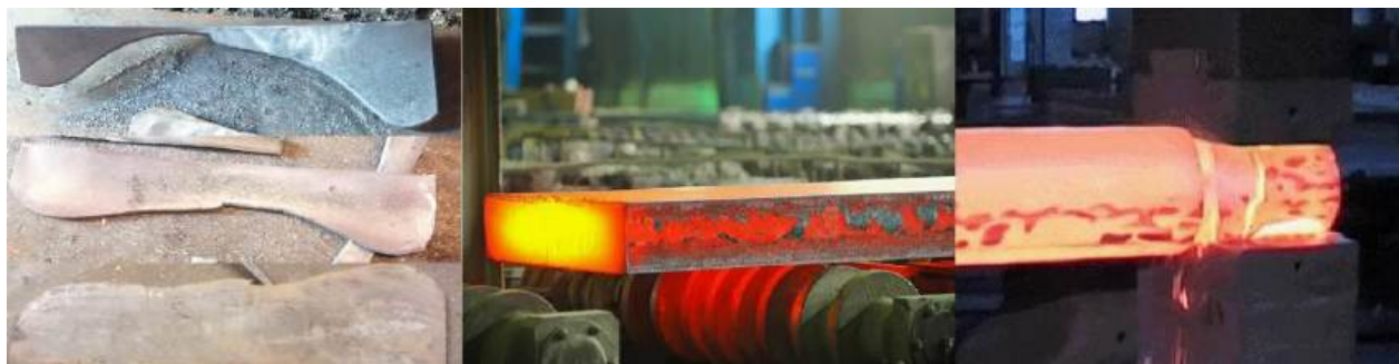
Рисунок 1 – Обрезаемые концы на раскате, окалина и угар возникающие в процессе прокатки
