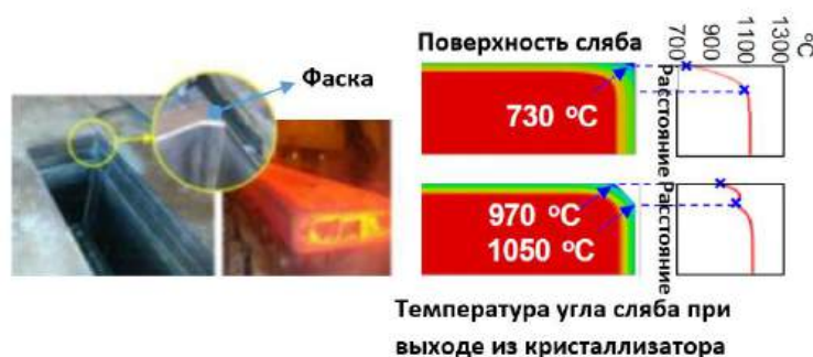
Рисунок 4 – Пример применения кристаллизатора с фасками
