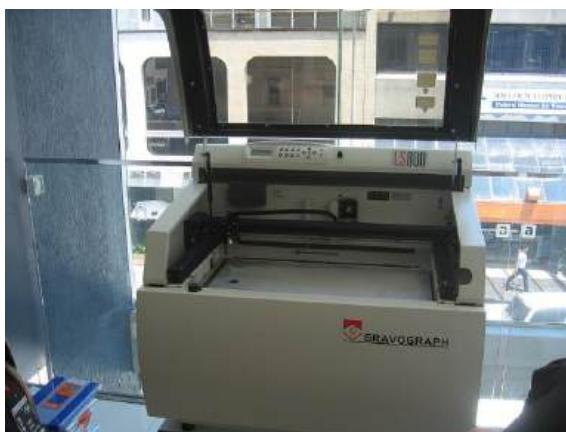
Рисунок 1 – Лазерный гравировальный станок Gravograph LS800.
