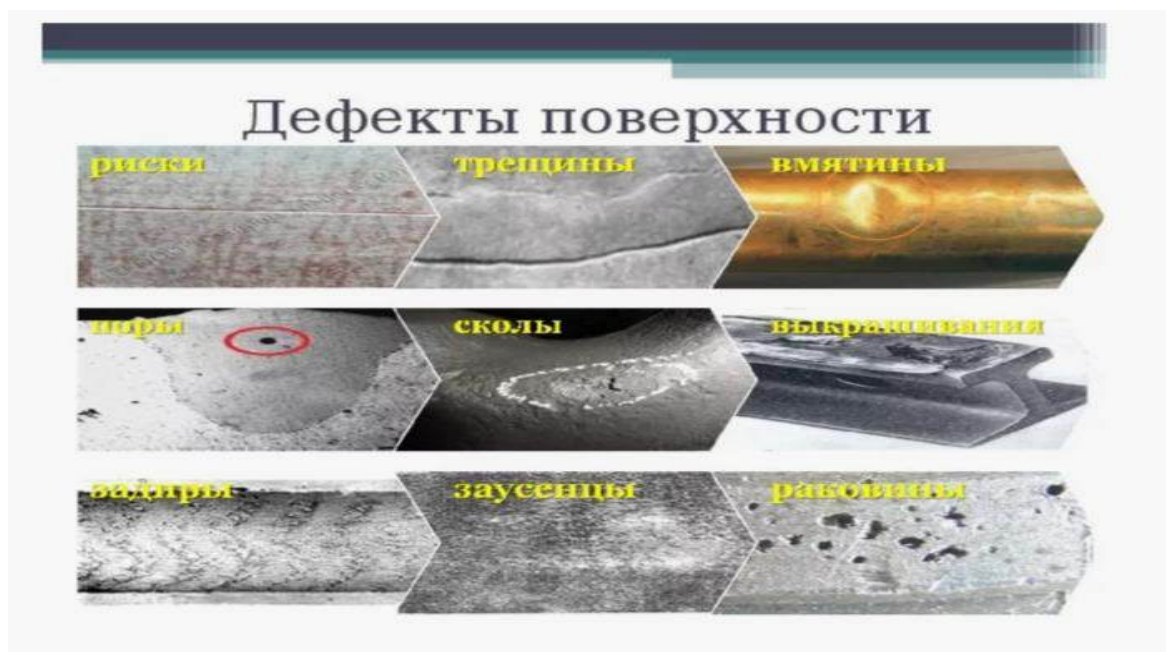
Рисунок 2 – Примеры дефектов поверхности слитков
