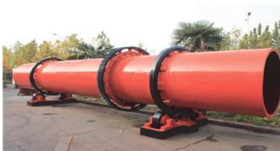
Рис. 1. Общий вид барабана роторной сушильной установки
