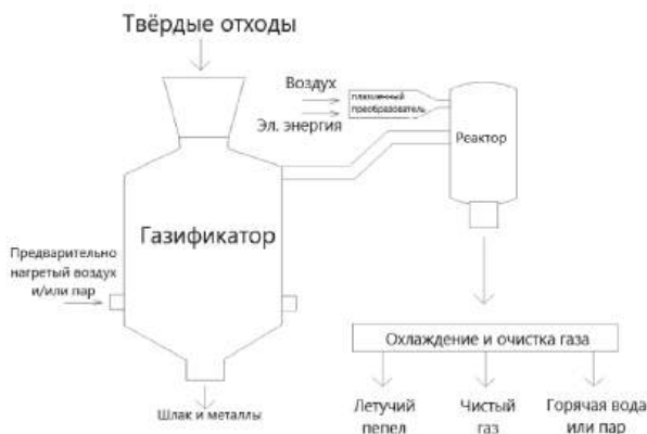
Рис. 1. Схема двухступенчатого процесса плазменной газификации
