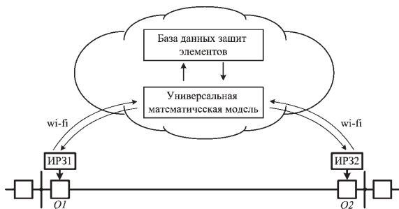
Рис. 2. Схема замещения для описания вида взаимной связи устройств релейной защиты через облако: Q1, Q2 – автоматические выключатели
